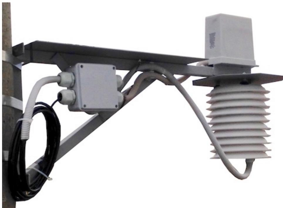
Рис.6 Рама внешних датчиков, закрепленная на столбе при помощи металлической лены
